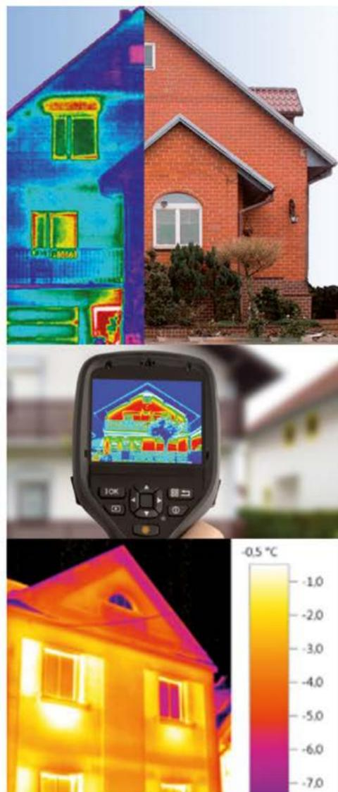
Come fare a capire se la vostra abitazione vi tradisce oppure no? Facile! Basta svolgere un'analisi termografica, ovvero una valutazione non invasiva, da eseguire in inverno (periodo di riscaldamento), che permette di scoprire se esistono oppure no zone di dispersione di calore. In caso di necessità, successivamente si potranno prendere provvedimenti mirati e consapevoli.
